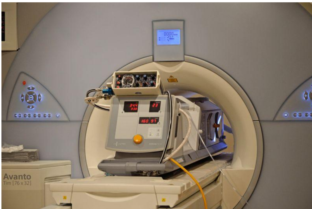
Foto 3: Mit dem nomag® IC kann das Frühchen direkt in den MRT
